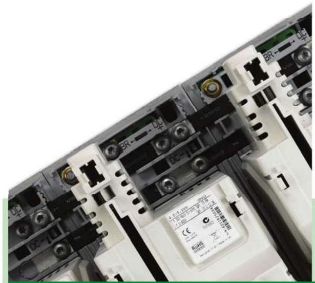
Cấu hình DC bus chung cho phép năng lượng hâm sử dụng lại bên trong hệ thống biến tần
