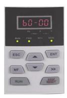
Fig. 4-9 First-tier display of parameter
