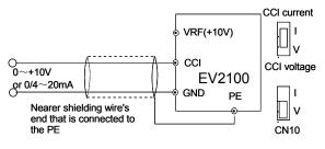
Fig. 3-15 Wiring CCI
