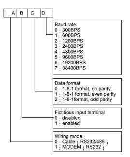
Fig. 5-58 communicating parameters
