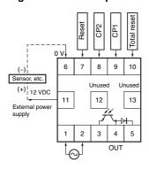
H7CX-A11/-A114/-A11D1/-A114D1 1-stage Contact Output
