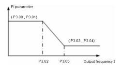
Figure 6.9 PI parameter diagram.
